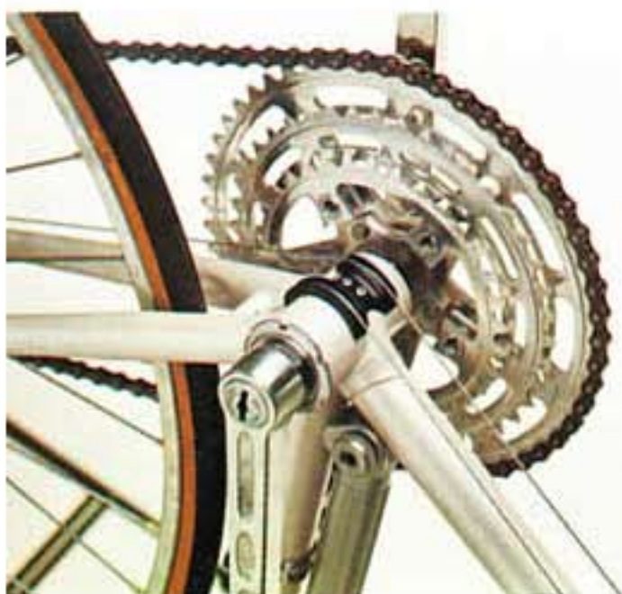
Detaljbild: Vevparti STRONGLIGHT 49 Triplex Dural, Glidskenor för växelwire.
